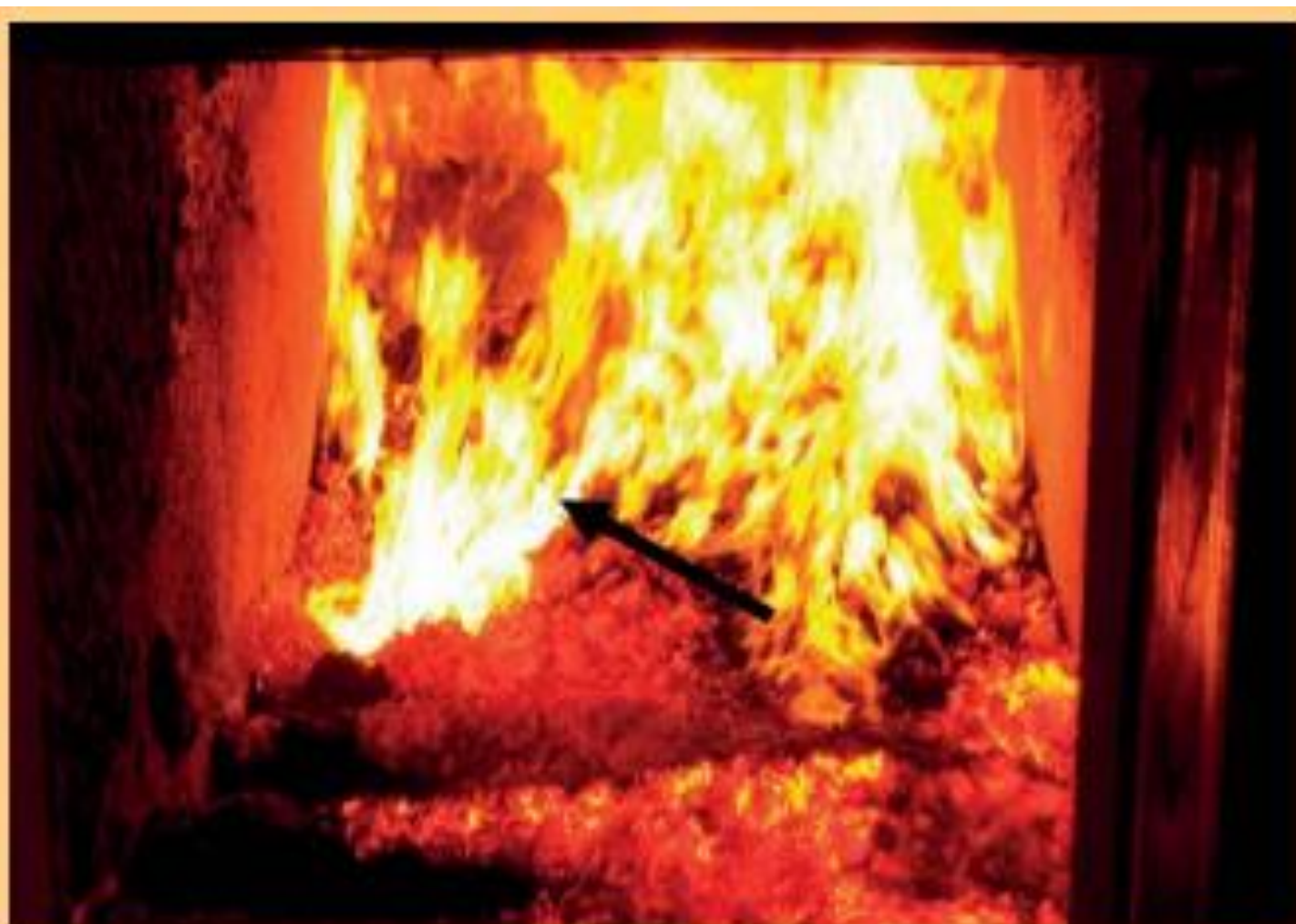
Excédent d'air avec hot spot (flèche) et scorification
