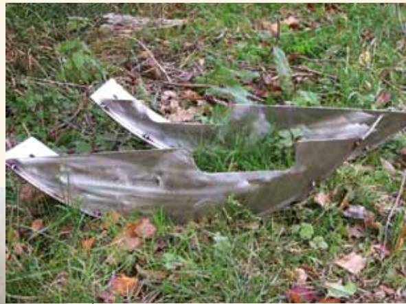
Détail des seuils en acier inoxydable.
